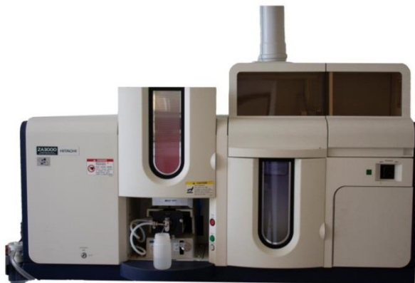
Рисунок 5.3. Атомно-абсорбционный спектрометр (ААС) ZA3000
