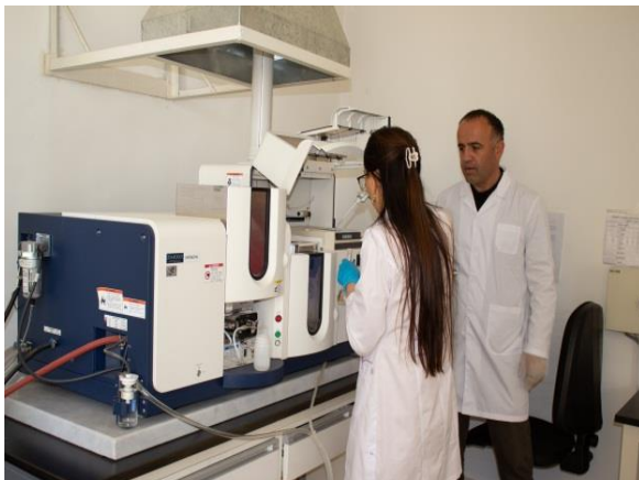
Рисунок 5.5 Процесс лабораторных исследований: А - на атомно-абсорбционном спектрометре ZA3000; Б – на ионном хроматографе Dionex ICS-900
