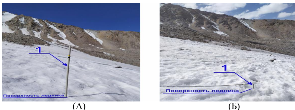
Рисунок 13. - Установленная абляционная рейка с разницей на один год. 1- рейка. А -установка реек (2020г.), Б - год сбора данных (2021г.)
