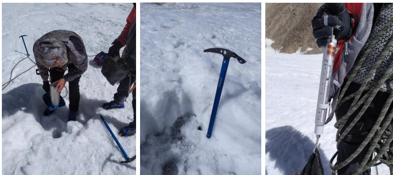
Рисунок 3.12. - Копание шурфа в зоне аккумуляции ледника, 2021 год. А-взяты образец снега для взвешивания, Б- высота снежного покрова в шурфе, В-взвешивание снега для определения его массы
