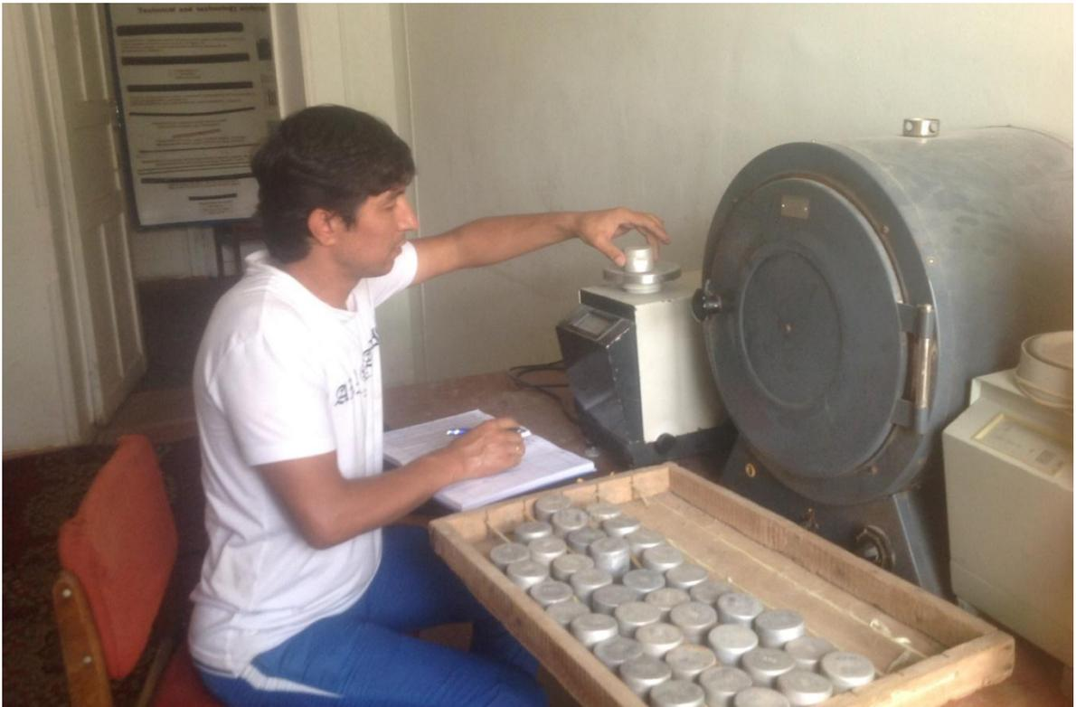
**Рисунок 4.1. Определение влажности почвы термостатно-весовым методом**
