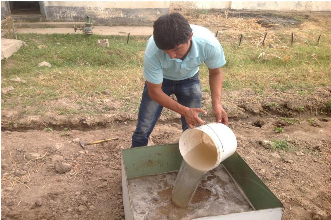
**Рисунок 4.4. Определение водопроницаемости почвы**
