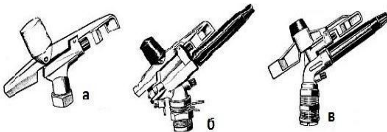
Рисунок 1.1. - Дождевальные аппараты: а - Роса 1, б - Роса 2 и в - Роса 3
