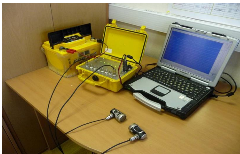
Расми 2.18. – Маҷмӯи таҷҳизоти ултрасадоӣ барои мақтаъсозии дар сатҳи бетонҳо ва намунаҳои чинсҳои кӯҳӣ
