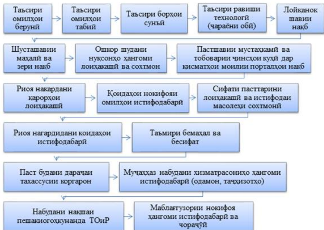
Расми 4.7. – Омилҳои асосии ба вайроншавӣ оварда расонидани нақбҳои гидротехникӣ ва иншооти обёрӣ
