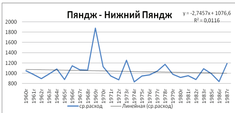
Рис. 4.5 Изменение расходов воды (м³/с) на р. Пяндж пост Нижний Пяндж за базовый период.
