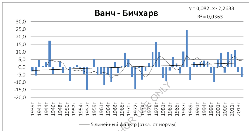
Рис. 4.14. Отклонение средних годовых расходов воды ( \text{м}^3/\text{с} ) от среднего за базовый период на р. Ванч пост Бичхарв за период наблюдений 1939-2014гг.
